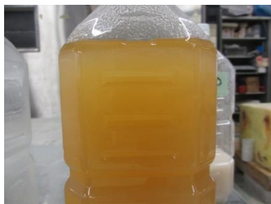
写真-1 表面含浸材の外観
